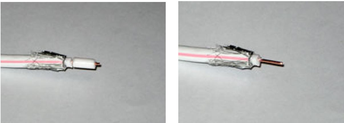
Отступая 2-3 мм от фольги сделайте надрез по кругу и снимите изоляцию не повреждая центральный проводник.
