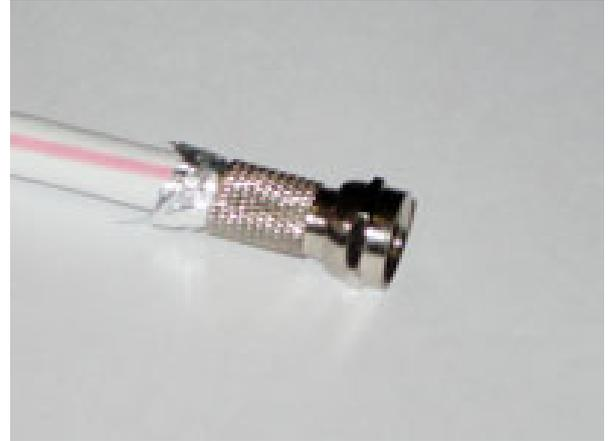
Накрутите F-разъем на кабель поверх изоляции на расправленные проводники оплетки и фольгу. Излишки фольги и оплетки, выступающие из под разъема, можно срезать ножом. Старайтесь не повредить при этом изоляцию.
